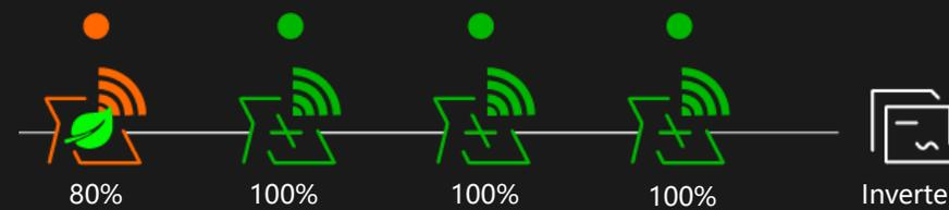
MPPT a livello di modulo, ottimizzato individualmente, senza impatti sui moduli collegati
